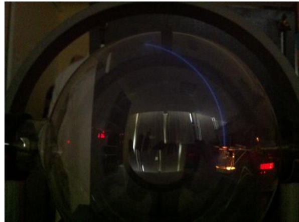
Vue de face lorsque le courant circule dans les bobines, donc en présence du champ magnétique
